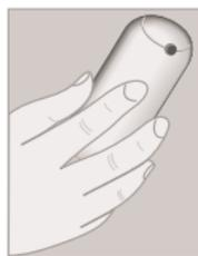
Nezakrývejte zbytečně telefon nad krytem akumulátoru. Kvalita příjmu by se snížila (integrovaná anténa).
